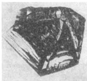
Abb. 5. SiC-Kristalle nach dem Erhitzen. (Vergr. 100fach.)
